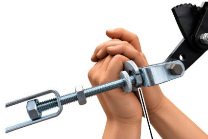
Adjust the handbrake cable
