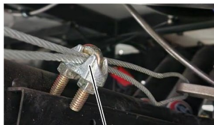
Remove handbrake cable
